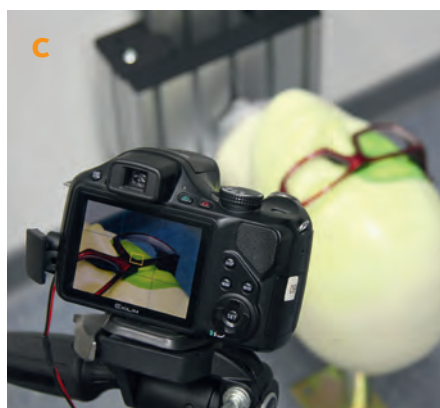
Abb. 1: Sportwissenschaftliche Tests im RUB-Labor (entsprechend DIN 58184).
